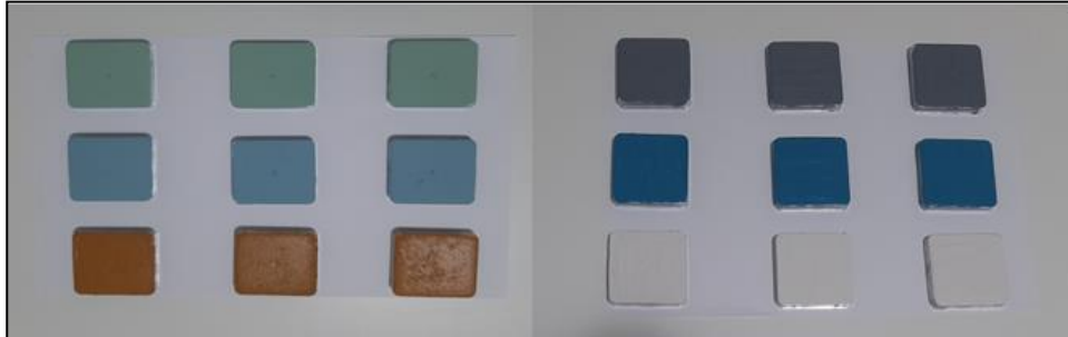
Figura 3.11 – Corpos de prova ensaio visando determinação do teor de voláteis
