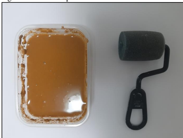
Figura 4.15– Protótipo da tinta à base de silicato de sódio
