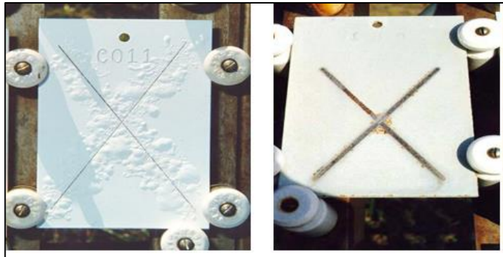
Figura 2.12 Cortes na forma de X em amostras de tintas aplicadas
